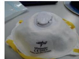
Abb. 2: FFP2-Maske mit deformiertem Ausatemventil, sterilisiert bei 121°C Dampfsterilisation
